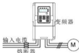
图 3-7 熔断器配置图
