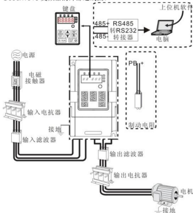
**注意：选择 C3 输入滤波器时，C3 输入滤波器并联在变频器的输入端。**
