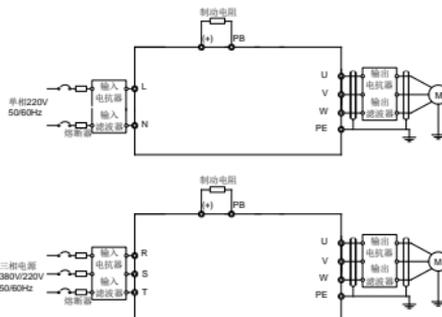
图 3-3 主回路接线图
