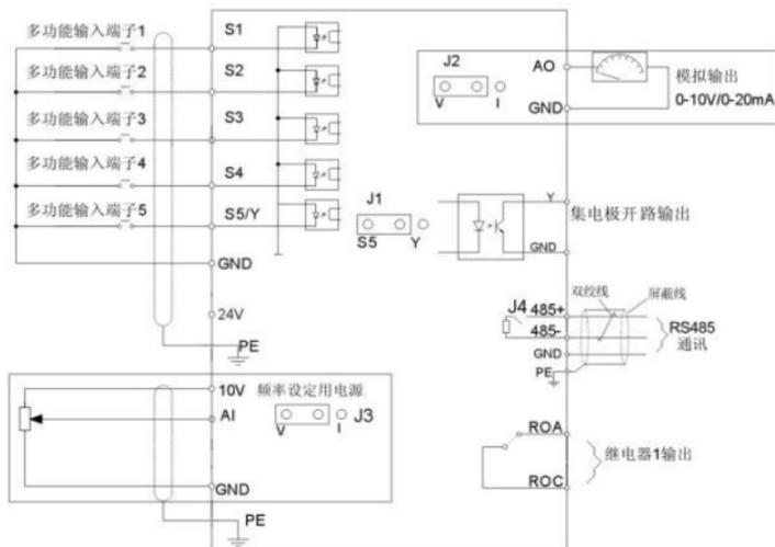
图 3-5 控制回路接线图
